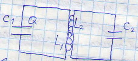
Оба колебательных контура не связаны между собой и цепь не образуют, однако катушка  $L_1$  находится возле катушки  $L_2$ , поэтому они могут влиять друг на друга за счет внешнего электромагнитной индукции.
