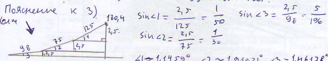
Тогда общий угол ската  $\alpha \approx 1,4325^\circ$  на ~~227 м~~ 227 м.
