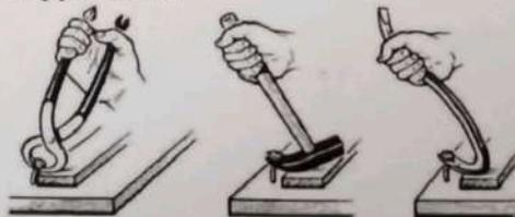
Ответ ручки инструментов выполняют функцию рычага. Инструменты: цинка, молоток- гвоздодёр, гвоздодёр
